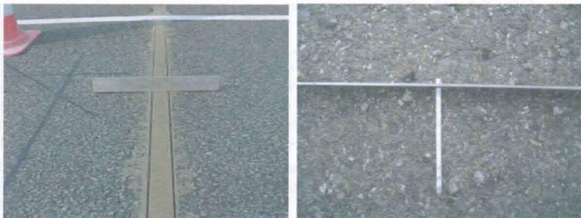
Рис. 1: Тест сорока сантиметровой планкой и измерение глубины колеи планкой длиной 2-4 м. (Источник: Kistler – Installation Instructions)
