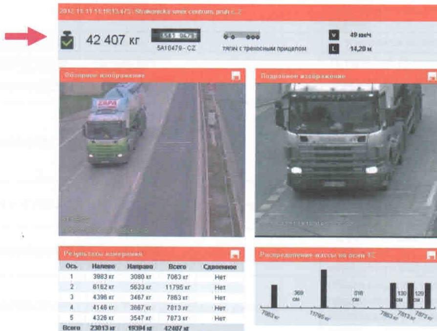
Рис. 13: Измерения соответствуют требованиям - детали
