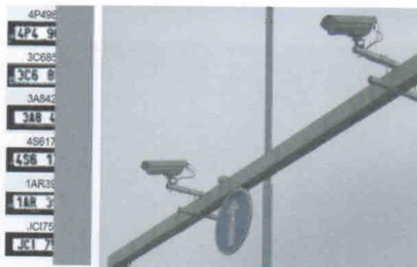
Рис. 9. Пример обнаруженных и прочтенных номерных знаков камерой
